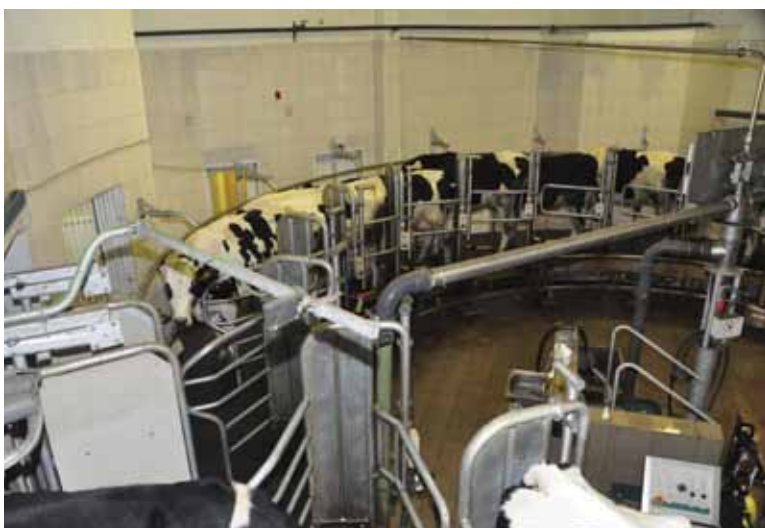
Karuseļa tipa slaukšanas iekārtā 15 minūtēs var izslaukt 20 govīs
