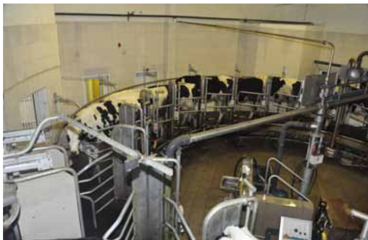
Оборудованием карусельного типа за 15 минут можно выдоить 20 коров
